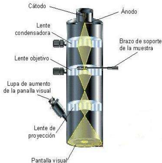
Figura 3.14 Diagrama de un microscopio electrónico de transmisión
