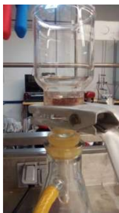
Figura .3.3 Filtración a vacío del tiomolibdato de tetrahexilamonio
