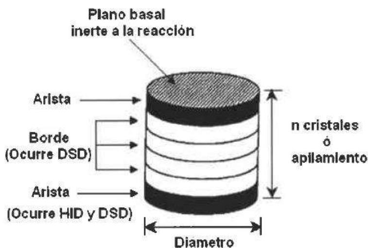
Figura 2.8. Representación del modelo borde-arista del sulfuro de molibdeno (Chianelli y Daage, 1994).
