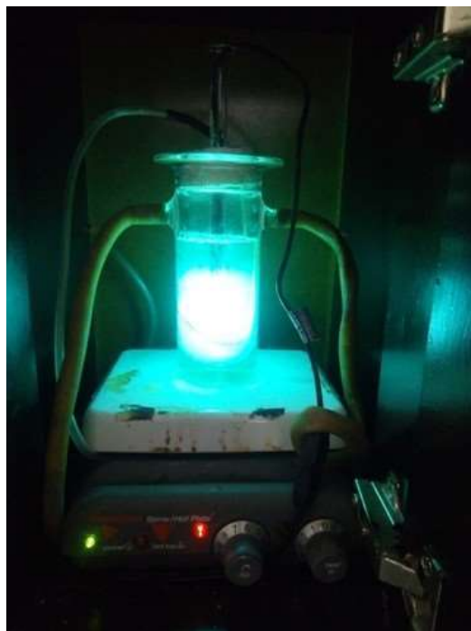
Figura 4.19 Inicio de la activación fotocatalítica mediante luz ultravioleta (UV).
