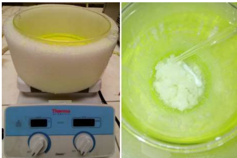
Figura 4.9 Proceso de reacción sol-gel a temperatura constante de 15 °C.
