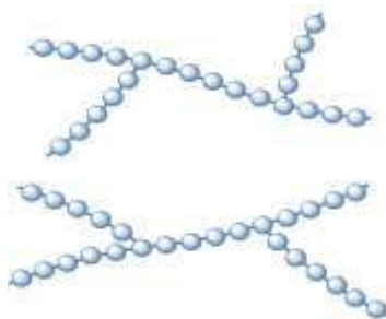
Figura 2.3 Estructura de un polímero ramificado.
