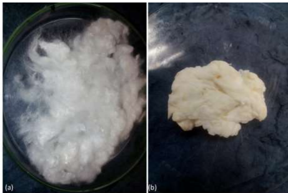
Figura 4.11 fibra Ceiba (a) pretratada antes de la inmersión en el sol-gel y (b) después de los procesos de inmersión en el sol de \text{TiO}_2 , lavada y secada.
