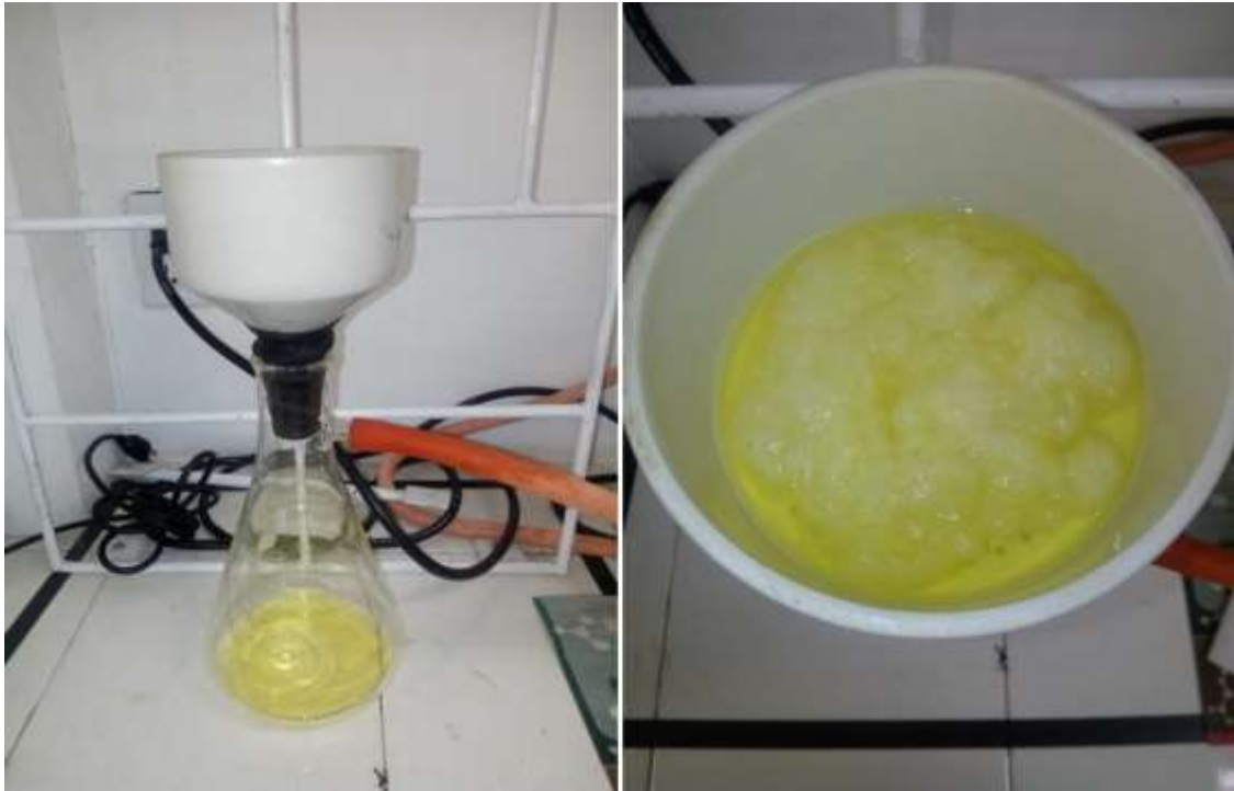
Figura 4.2 Lavado de la fibra Ceiba pretratada hasta pH neutro.
