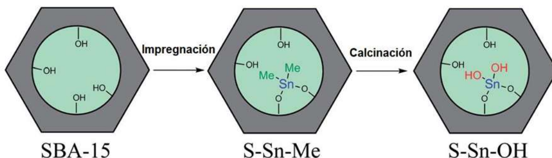
Figura 3, Método de síntesis para la formación de sitios ácidos de Brønsted mediante el uso de cloruro de dimetil-estaño (IV) de acuerdo a Wang y col. 2014 28 .
