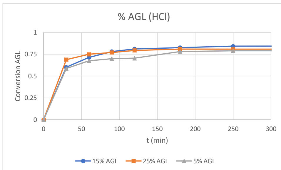
Figura 4.3h. Conversión de (AGL) con distintas cantidades de ácido oleico inicial, utilizando ácido clorhídrico como catalizador.
