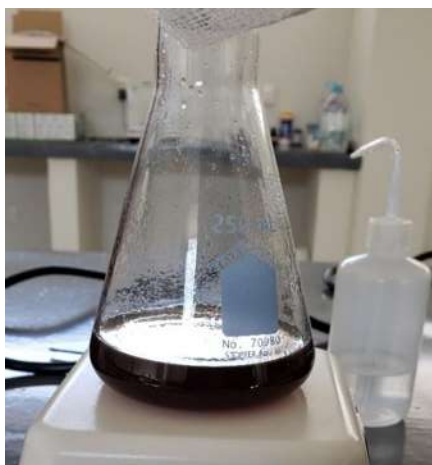
Figura 4.5a. Reacción de la mezcla oleosa con metanol al colocar directamente la cantidad de ácido necesario para la esterificación.
