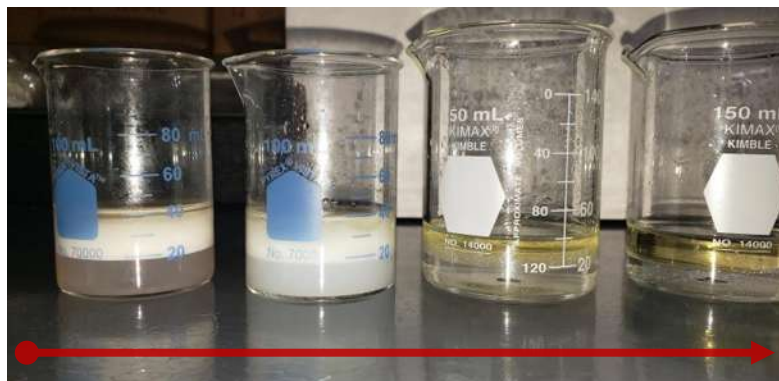
Figura 4.5g. Primera dilución de agua alcalina en presencia de la mezcla oleosa.
