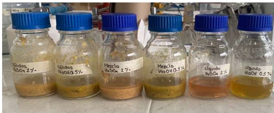
Figura 4.3. Muestras de desperdicios de alimentos con NaOH/H 2 SO 4 antes de someter a pretratamiento térmico en autoclave.
