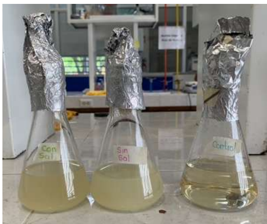
Figura 4.9. Fermentaciones en medio mineral AM1 adicionado con glucosa fructosa y arabinosa (hidrolizado simulado).
