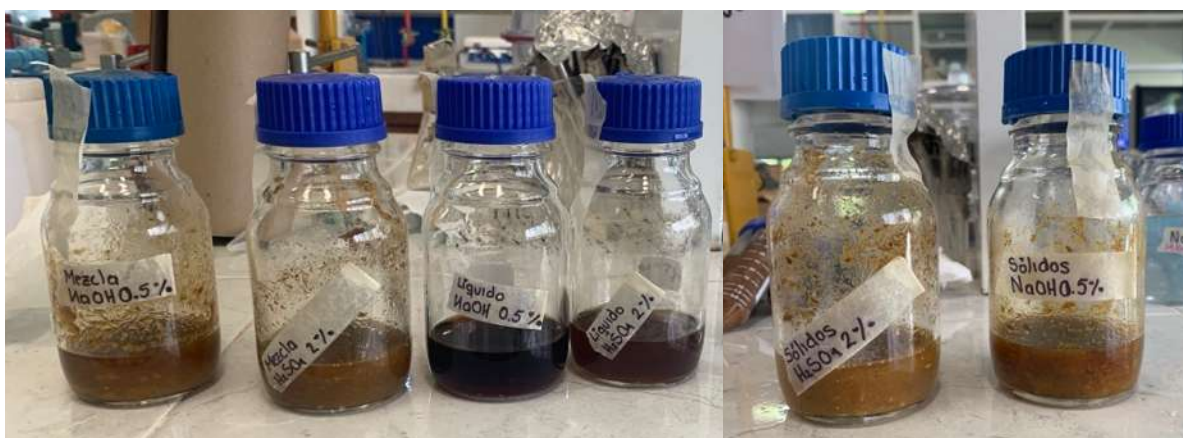
Figura 4.4. Muestras de desperdicios de alimentos después del pretratamiento termoquímico.
