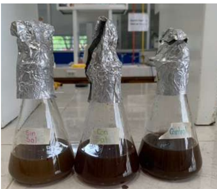
Figura 4.11. Fermentaciones en hidrolizado de alimentos complementado con medio mineral AM1.
