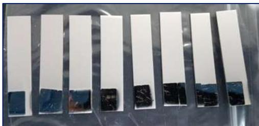
Figura 15. Muestras con recubrimiento de Ti (50x10x1 mm).
