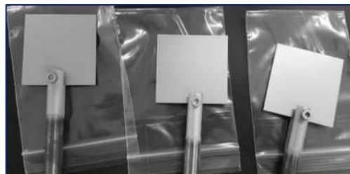
Figura 16. Muestras con recubrimiento de Ti (50x50x1 mm).
