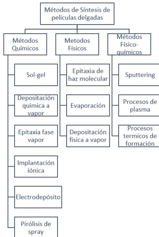
Figura 3. Métodos de Síntesis de películas delgadas
