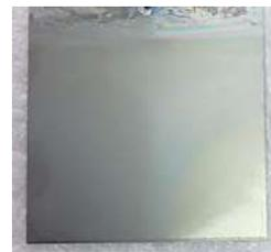
Figura 20. Película de  $\text{TiO}_2$  (50x50x1 mm)
