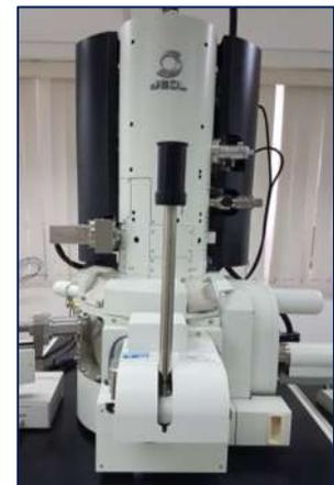
Figura 30. Microscopio electrónico de barrido.
