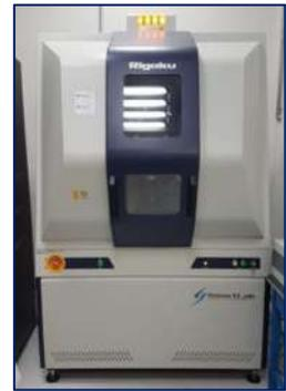
Figura 44. Difractómetro de rayos X.
