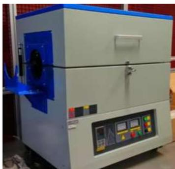
Figura 21. Horno de tubo para tratamiento térmico.
