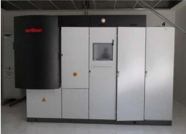
Figura 12. Equipo PVD marca DOMINO Mini de OERLIKON.
