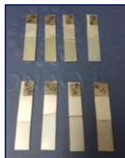
Figura 19. Muestras anodizadas con diferentes parámetros (50x10x1 mm)
