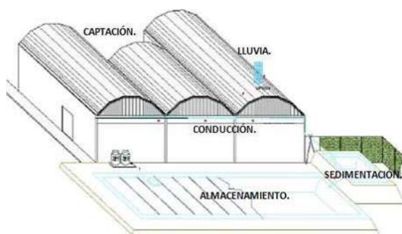
Figura 1.21 Planta purificadora de agua de Lluvia COLPOS 3. (en la figura izquierda se muestra el prototipo del diseño y en la derecha la implementación del SCALL), Fuente: CIDECALLI – CP 2008.
