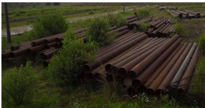
Figura VIII Tubería de 6" de Acero inoxidable que se adquirió para la línea de conducción de la comunidad de Sevina al Campus Universitario quedo sin uso debido a la cancelación de la obra. Fuente: Foto tomada por CRS.
