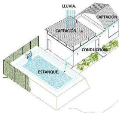
Figura 1.20 Estanque para peces de ornato y comestible y riego de huerto familiar COLPOS 2. (en la figura izquierda se muestra el prototipo del diseño y en la derecha la implementación del SCALL., Fuente: CIDECALLI – CP 2008.
