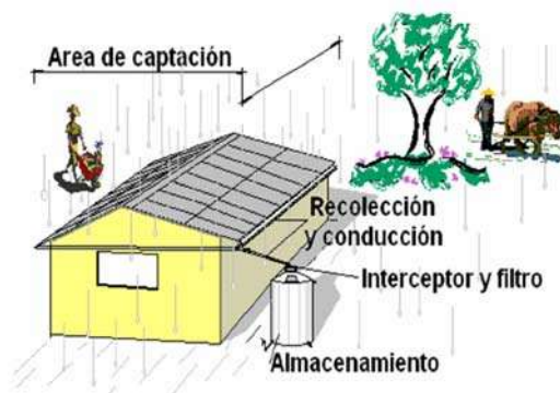
Figura 1.1 El área de captación que se debe considerar en un sistema, es dirección horizontal del techado o de la cubierta. Fuente: (Caballero Aquino T., 2006)
