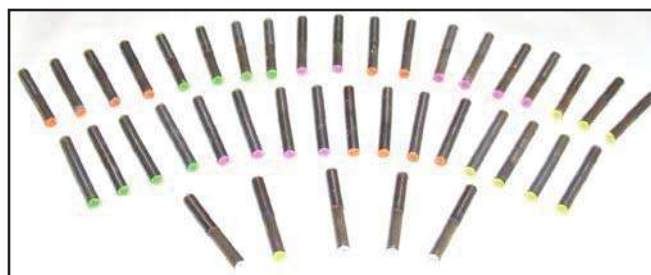
Figura 3.7 Muestras unidas para ser evaluadas por flexión.
