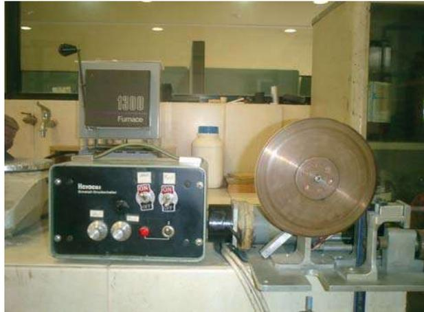
Figura 2.3. Aparato de extracción de fibras.
