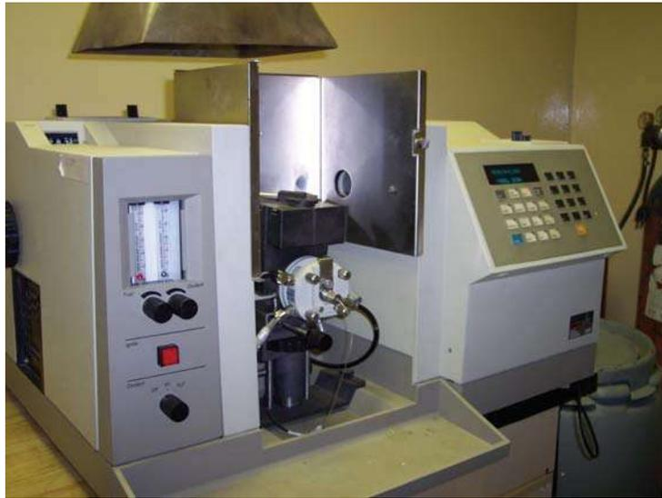
Figura 3.8. Equipo de espectrometría de absorción atómica (EAA). Perkin Elmer 3100.
