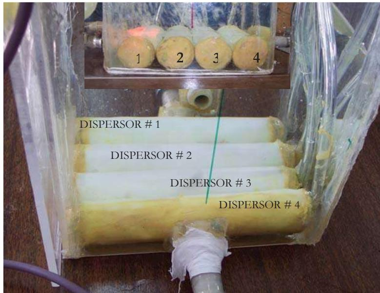
Figura IV.41. Imagen digital de la ubicación de la batería de dispersores cilíndricos en la celda de flotación. Los dispersores fueron numerados a partir de la entrada de alimentación.
