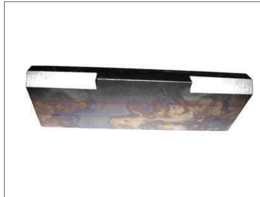
Figura 2.5. Maquinado final de la probeta, sección B con bisel escalonado.
