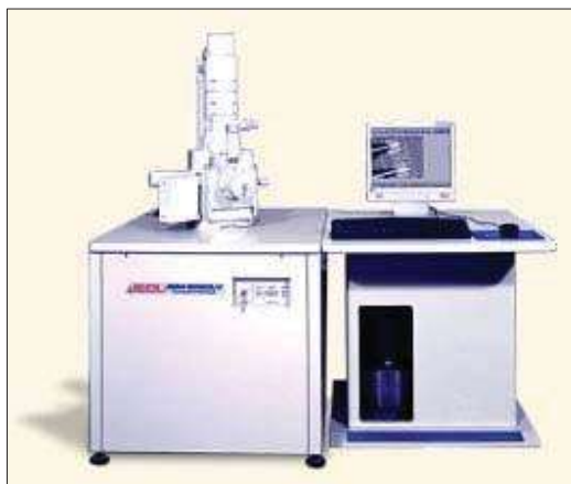
Figura 2.23. Microscopio electrónico de barrido JEOL modelo JSM-5910LV.
