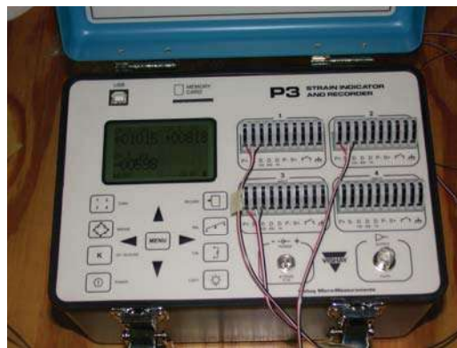
Figura 2.15. Medidor y registrador de micro deformaciones marca Vishay modelo P3.
