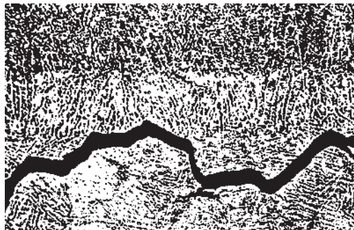
Figura 1.45. Agrietamiento inducido por hidrogeno en la zona parcialmente fundida de un acero HY-80 66 .
