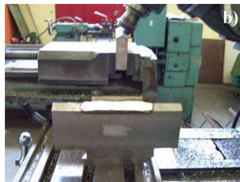
Figura 2.7. a) Aplicación de cordones de soldadura de enmantequillado; b) Rectificado del espesor.
