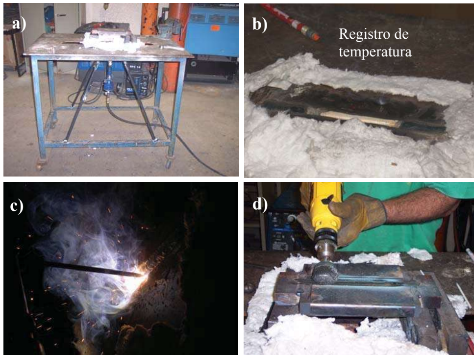
Figura 2.9. Procedimiento de soldadura de relleno acero AISI H-13.
