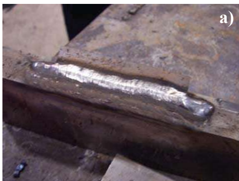
Figura 2.7. a) Aplicación de cordones de soldadura de enmantequillado; b) Rectificado del espesor.
