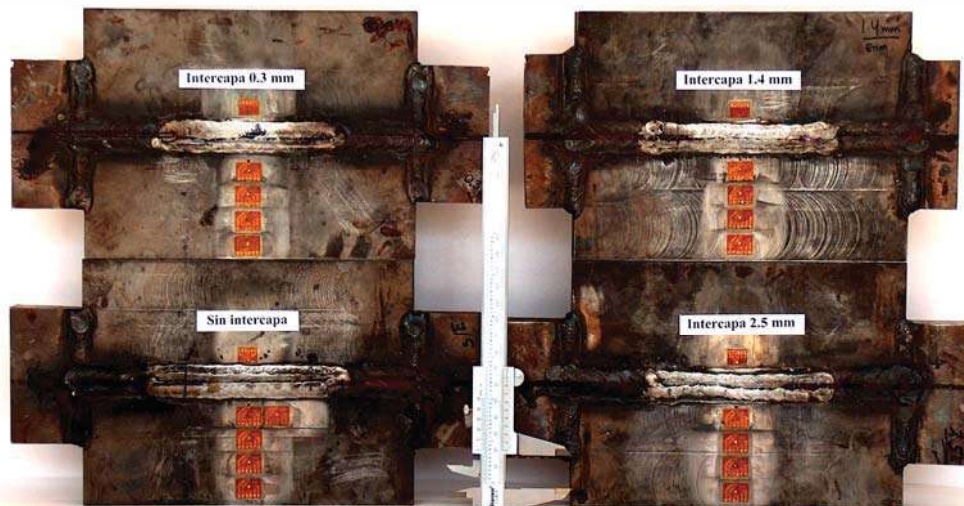
Figura 2.17. Ubicación de los diferentes puntos de medición de esfuerzos residuales por medio de la técnica de “Hole Drilling” para las diferentes probetas.
