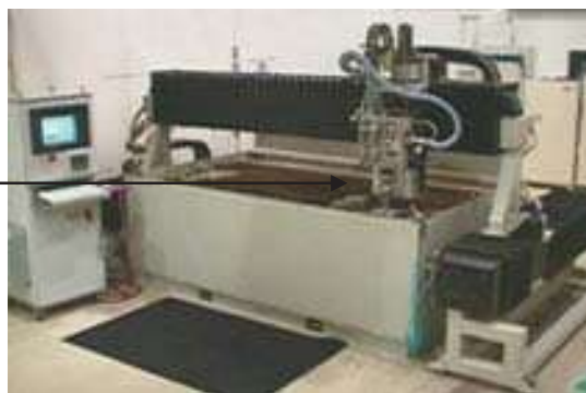
Figura 2.18. Máquina de corte por agua (Water Jet) marca Flow.
