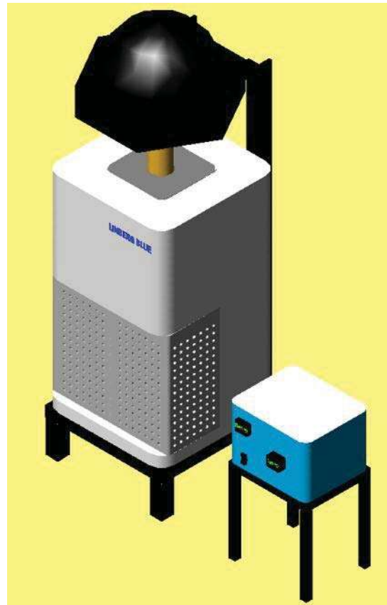
Figura 3.3 Horno tubular de alta temperatura con atmósfera controlada.
