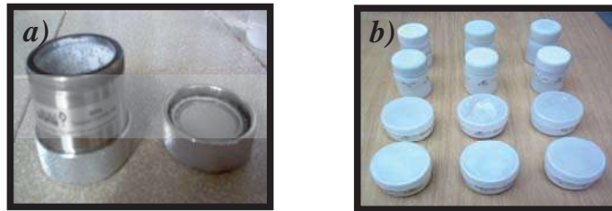
Figura III.4. Recuperación de los polvos. a) Vial (804) con los polvos obtenidos después de la molienda y b) Polvos recuperados colocados en contenedores de plástico.
