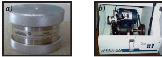
Figura III.3. Proceso de molienda. a) Vial (804) con los polvos preparados y b) Disposición del vial en el molino SPEX 8000-M.
