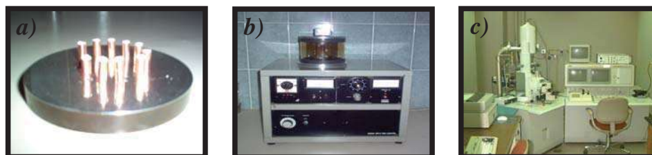
Figura III.7. Caracterización por MEB. a) Soporte de acero con los polvos preparados en cilindros de cobre, b) Metalización de los polvos en un metalizador Edwards S150A y c) Microscopio electrónico de barrido JEOL JSM-6400.
