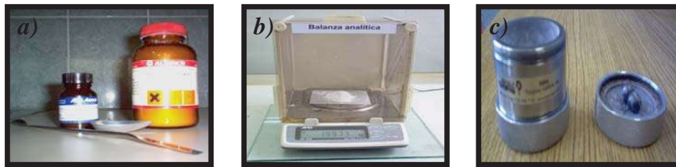
Figura III.2. Etapas de la preparación de los polvos. a) Polvos usados, b) Pesado de los polvos en la balanza analítica y c) Cargado de los polvos en el contenedor.
