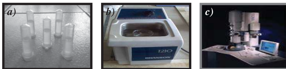
Figura III.8. Caracterización por TEM. a) Microtubos MCT-200-C con alcohol isopropílico y polvos de BN, b) Dispersión de los polvos en vibrador BRANSON 1210 y c) Microscopio electrónico de transmisión PHILLIPS TECNAI F-20.
