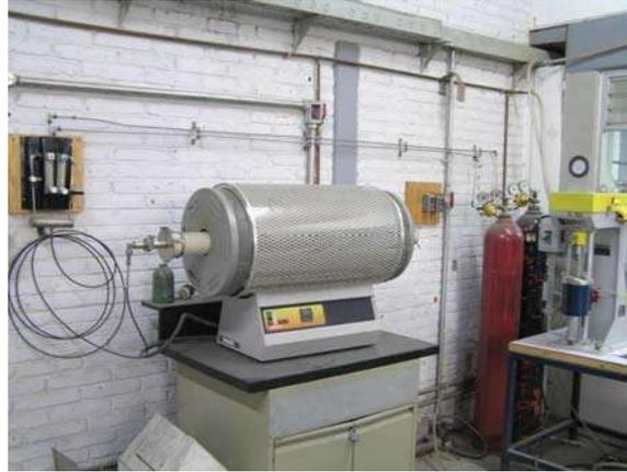
Figura 3.5 Horno Tubular empleado en los experimentos de unión.
