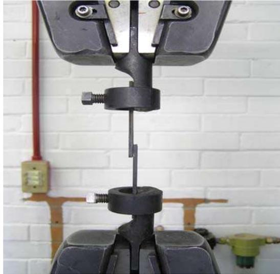
Figura 3.9 Uniones montadas en mordazas especialmente diseñadas para realizar la prueba mecánica.
