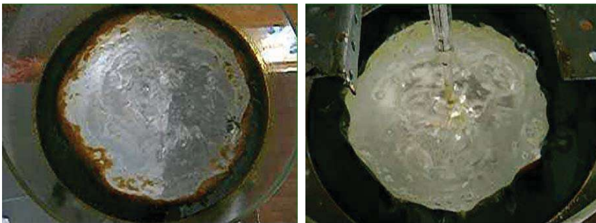
Figura 4.47. Diferencias en la magnitud del área expuesta cuando la inyección se hace con: (a) tapón poroso y (b) lanza no consumible a flujo de 5 l/min con el aceite \mu=5000 cSt.
