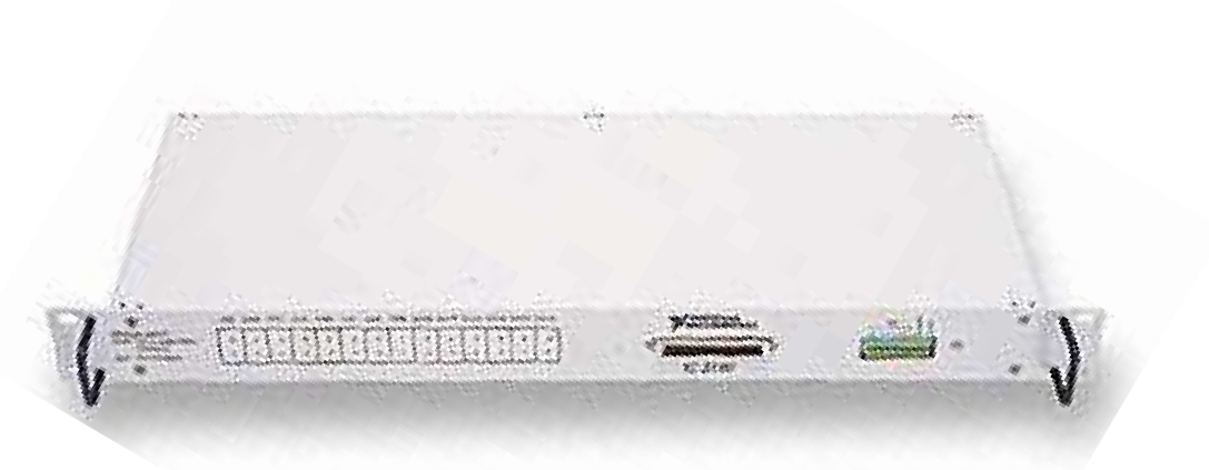
Figura 3.5. Tarjeta NI-4351 con elemento auxiliar TC-2190.
