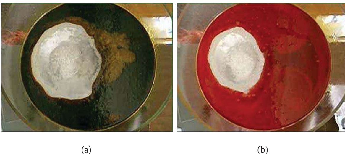
Figura 4.35. Tapón en la posición C. (a) aceite negro, \mu=5000 cSt: flujo de 1l/min, (b) aceite rojo, \mu=70 cSt: flujo de 1l/min.
