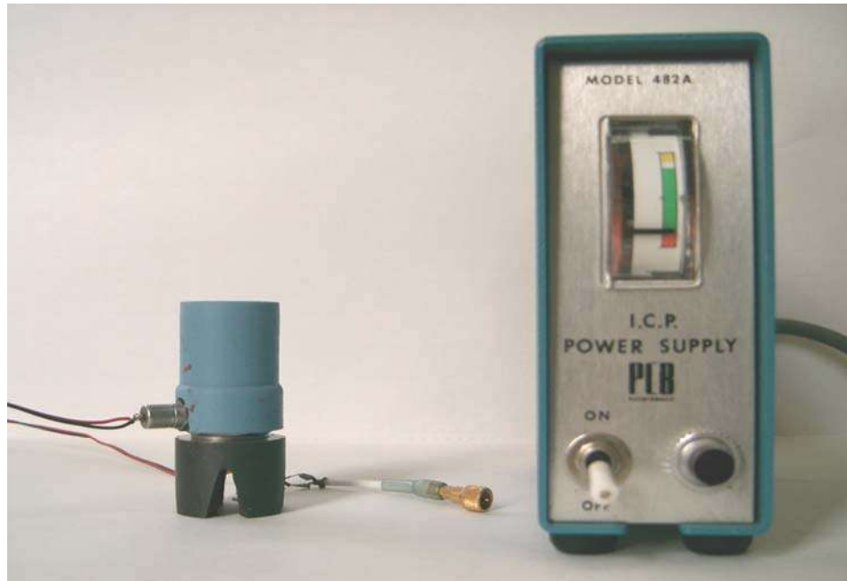
Figura 3.1 (a). Acelerómetro y unidad de suministro de energía.
