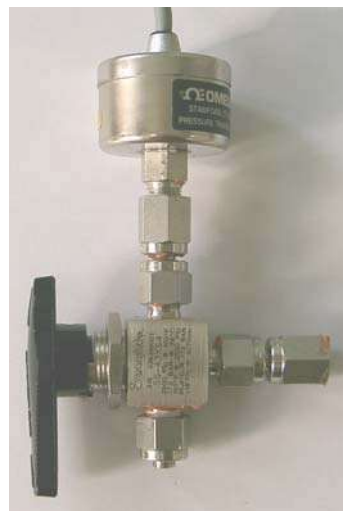
Figura 3.16. a) Transductor de presión OMEGA, b) Válvula SWAGELOK.
