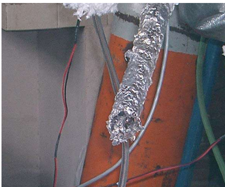
Figura 4.63. Lanza con costra de aluminio solidificado.
