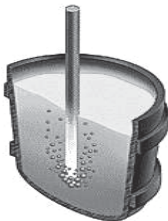
Figura 2.8. Inyección con lanza en una olla de refinación secundaria.
