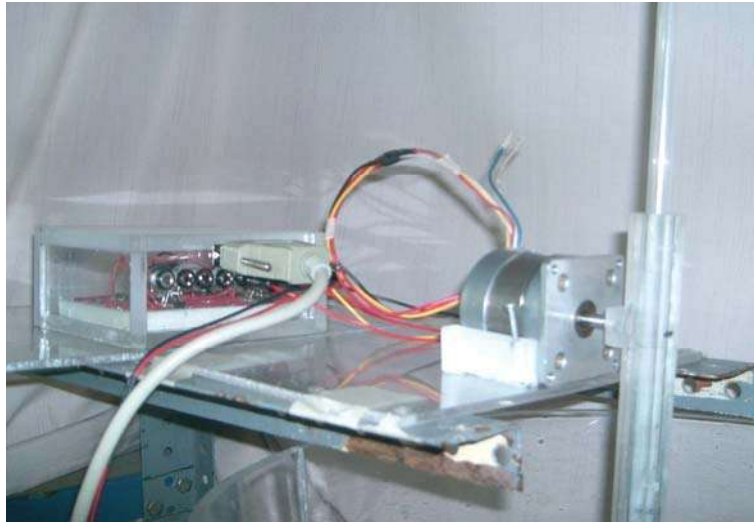
Figura 3.8. Lanza de inyección conectada al motor de pasos.
