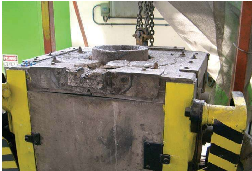
Figura 3.24. Prueba de la lanza en horno de inducción con aluminio líquido.
