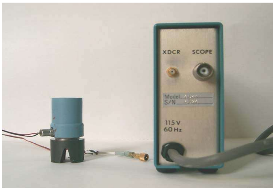
Figura 3.1 (b). Conexiones traseras del acelerómetro y la unidad de suministro de energía.
