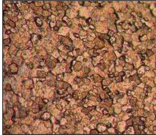
Figura 4.4. Microestructura típica de titanio atacado en 30 segundos.
