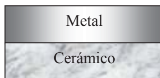
Figura 2.7. Interfase sin reacción y sin capa de difusión.
