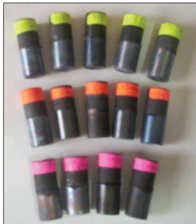
Figura 3.10. Muestras unidas para ser evaluados por corte.
