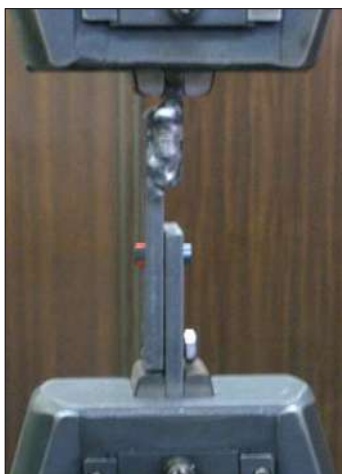
Figura 4.29. Muestra sometida al corte en el equipo utilizado para la evaluación.
