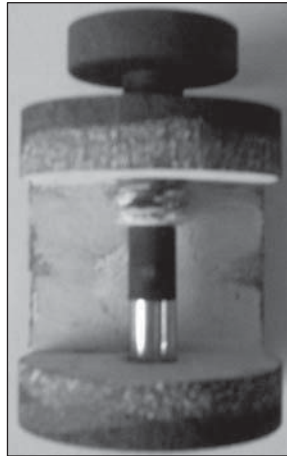
Figura 3.9. Diseño de la porta muestras de grafito.
