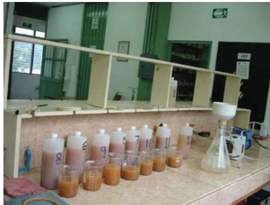
Figura IV.18.- Se observa el proceso de la prueba de vacío para los sedimentos líquidos.
