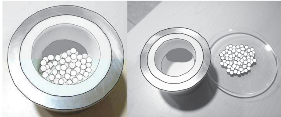
Figura 4.4. Agregado de partículas trabajando a 380 rpm, en un tiempo de 5 hrs. de molienda y con bolas de molienda de 0.5 cm.
