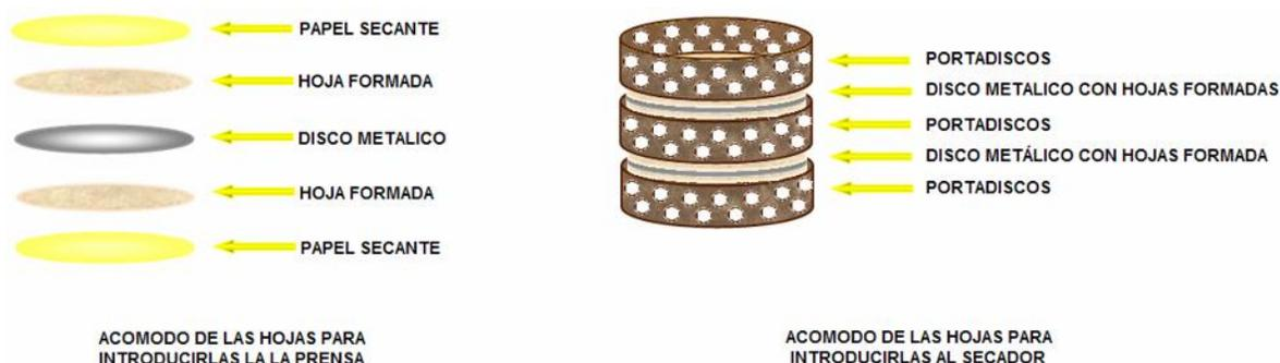
**Figura 3.9. Acomodo de los aditamentos para el prensado y secado de las hojas formadas.**
