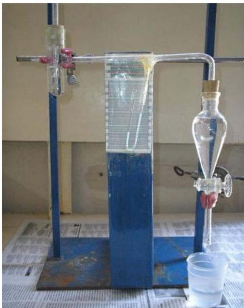
**Figura 3.5. Dispositivo para medir la tensión superficial de un líquido de acuerdo al principio de formación de la gota.**
