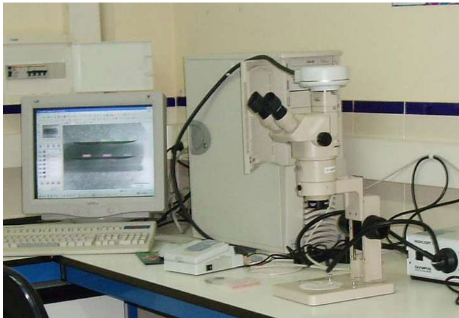
Figura 2.9. Microscopio estereográfico Olympus SZ-CTV, equipado con cámara y analizador de imágenes [LORTEK].
