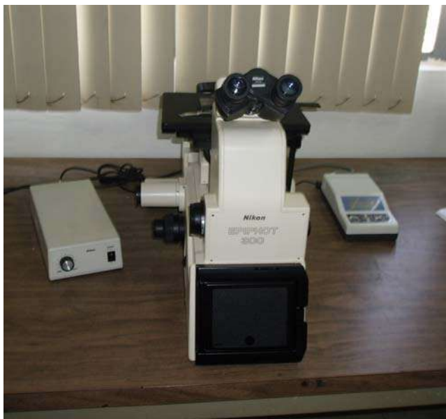
Figura 2.10. Microscopio metalográfico de platina invertida Nikon EPIPHOT 300 [I.I.M-U.M.S.N.H.].
