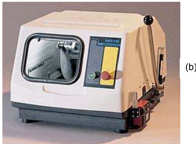
Figura 2.5 (a) La pletina de acero AISI-1045, se dividió en ocho partes, empleando una cortadora de disco (b).
