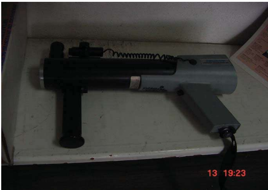
Figura 3.7.- Pirómetro óptico usado para determinar la temperatura Instantánea del hogar del horno de refractariedad.
