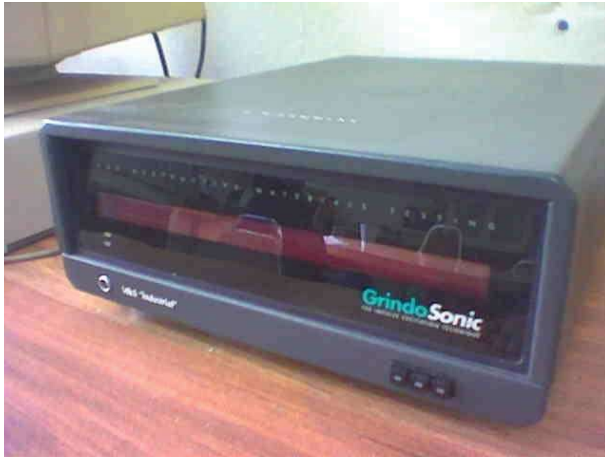
Figura 3.8.- Equipo GrindoSonic para la determinación del módulo de Young
