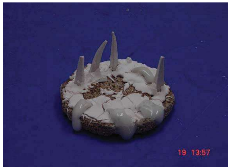
Figura 4.20.- Los conos pirométricos Orton™ se doblaron en el tercer proceso de quema, quedando únicamente los conos del material en cuestión.
