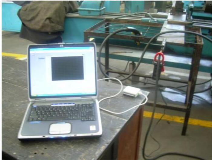
Figura 4.8 Ilustra la forma en que se hizo la medición de corriente.
