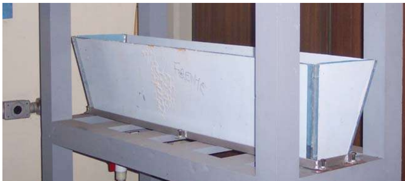
Figura 3.23, Distribuidor modelo en acrílico
