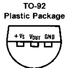
Figura 3.58, Vista inferior del LM35
