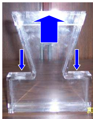
Figura 3.20, Construcción en acrílico de las cajas de viento utilizadas
