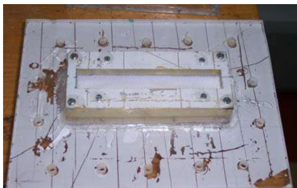
Figura 3.6, Vista en planta del burbujeador
