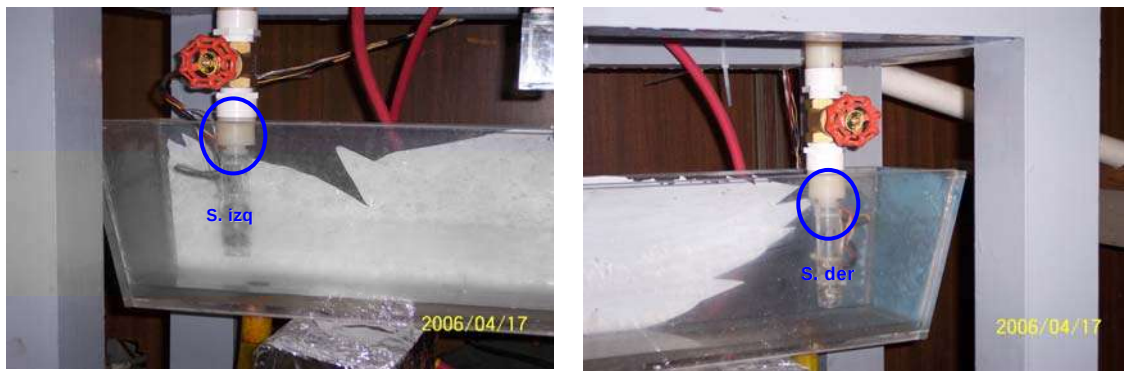
Figura 3.52, Ubicación de sensores en las descargas
