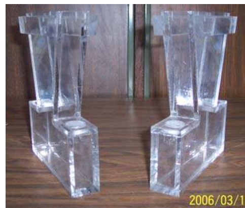
Figura 3.20, Construcción en acrílico de las cajas de viento utilizadas
