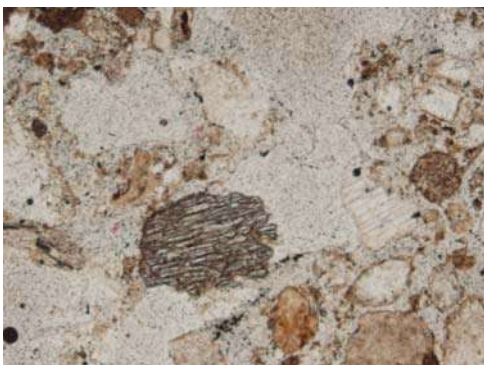
Figuras 25 y 26. Fenocristales de tamaño inequigranular.
