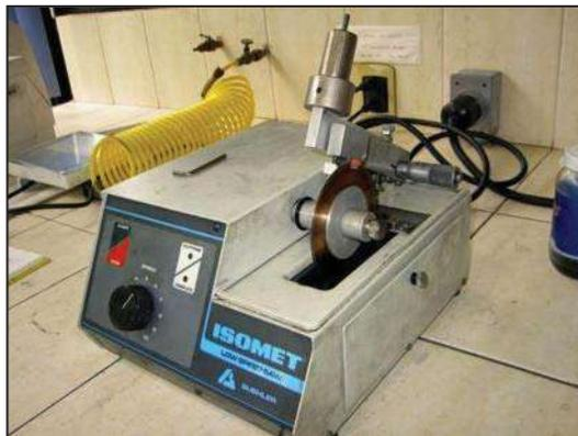
Figura 3.2. Cortadora de precisión con disco de diamante.
