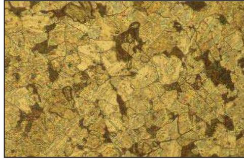
Figura 4.3 Micrografía del acero AISI 1018 sometida al ataque químico a 500X.
