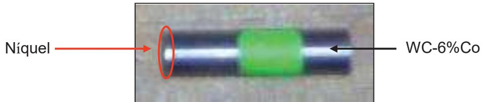
Figura 3.13. Esquema de una de las muestras fracturadas.
