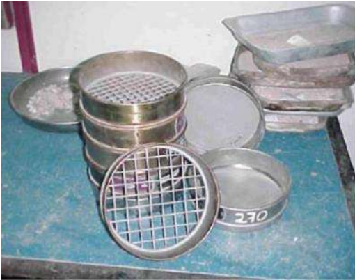
Fig. 14. Columna de tamices en orden, utilizados para el Análisis Granulométrico
