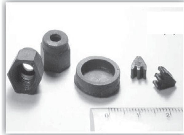
Figura 2.11 Nanocompuestos finales 5%vol. Ni/Al 2 O 3 producidos por colada de gel (gel casting) en varios modelos de formas complejas (tuercas, cilindros, partes de engranes) [45].
