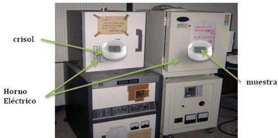
Figura 3.12 Horno eléctrico en el que se someten las muestras de \text{Ni}/\text{Al}_2\text{O}_3 a tratamiento térmico
