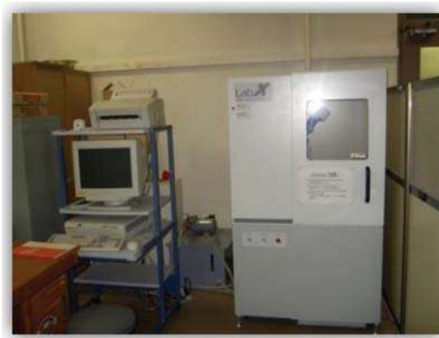
Figura 3.17 Equipo de difracción de rayos X usado para la caracterización de los compuestos \text{Ni}/\text{Al}_2\text{O}_3
