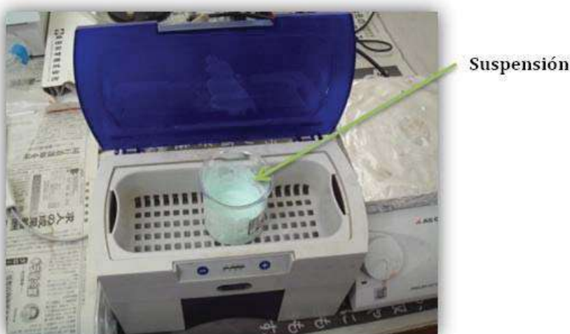
Figura 3.3 Tina ultrasonido empleada en la preparación de la suspensión precursora del compuesto \text{Ni}/\text{Al}_2\text{O}_3 .
