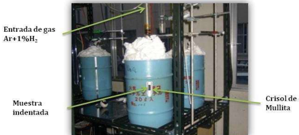
Figura 3.14 Horno eléctrico usado para el tratamiento térmico en atmósfera de Ar + 1%H 2 compuesto Ni/Al 2 O 3 indentado y tratado a las diferentes condiciones de T_H y t_H
