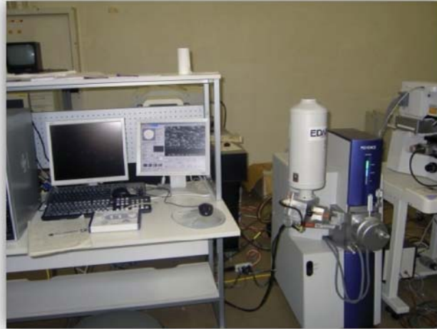
Figura 3.18 Microscopio electrónico de barrido usado para la caracterización de los compuestos \text{Ni}/\text{Al}_2\text{O}_3
