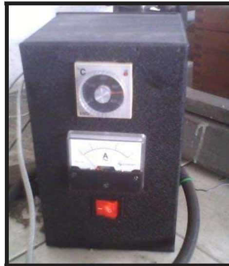
Figura 2.14 Ubicación de la resistencia eléctrica y control de temperatura utilizados en el ensayo de creep.
