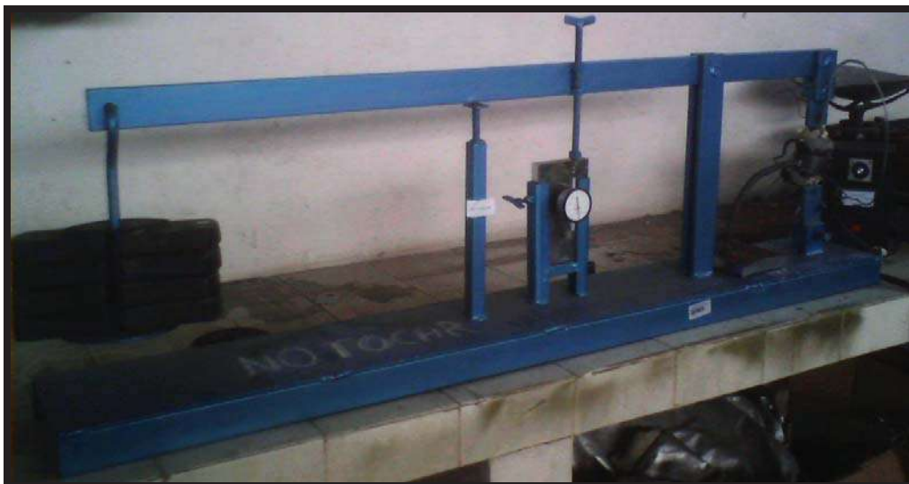
Figura 2.15 Ensayo de creep realizado a la aleación Mg96Al4 en condición de colada y a las aleaciones Mg96Al4 y Mg95.5Al3.5Li1 tratadas en solución ( T = 350\text{ }^{\circ}\text{C} por 3 horas).
