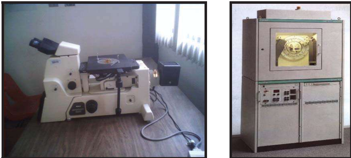
Figura 2.7 Microscopio óptico y difractómetro de rayos-X utilizados en la observación y en la adquisición digital de la microestructura de las aleaciones.
