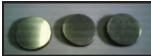
Figura 2.6 Secciones de la parte del fondo, la parte media y la parte superior de la aleación para realizar el análisis microestructural.
