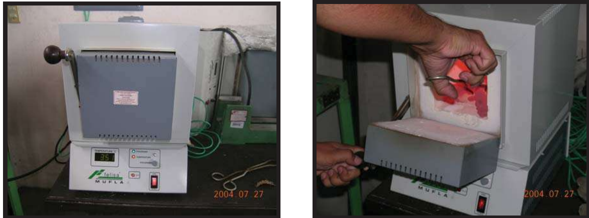
Figura 2.10 Horno de resistencias eléctricas utilizado para los tratamientos térmicos de solución (3 horas a 350 °C) y precipitación (2, 4, 6, 8, 12, 15, 18, 24, 30, 40, 50 horas a 180 °C) aplicados a las aleaciones.
