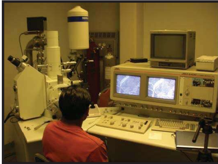
Figura 2.8 Microscopio electrónico de barrido utilizado en la caracterización de las aleaciones Mg96Al4 y Mg95.5Al3.5Li1 en condición de colada.
