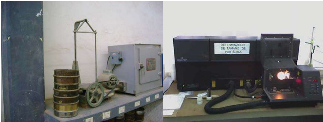
Figura 3.3.- A la izquierda se muestra un conjunto de mallas para la determinación de granulometría de la parte gruesa de la muestra. A la derecha se muestra una imagen del analizador de tamaño de partícula Coulter LS 100Q, que se utilizó para la determinación de la granulometría de la parte fina.
