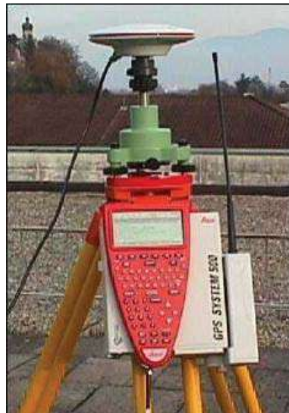
Fig. 7.- GPS Doble Frecuencia
