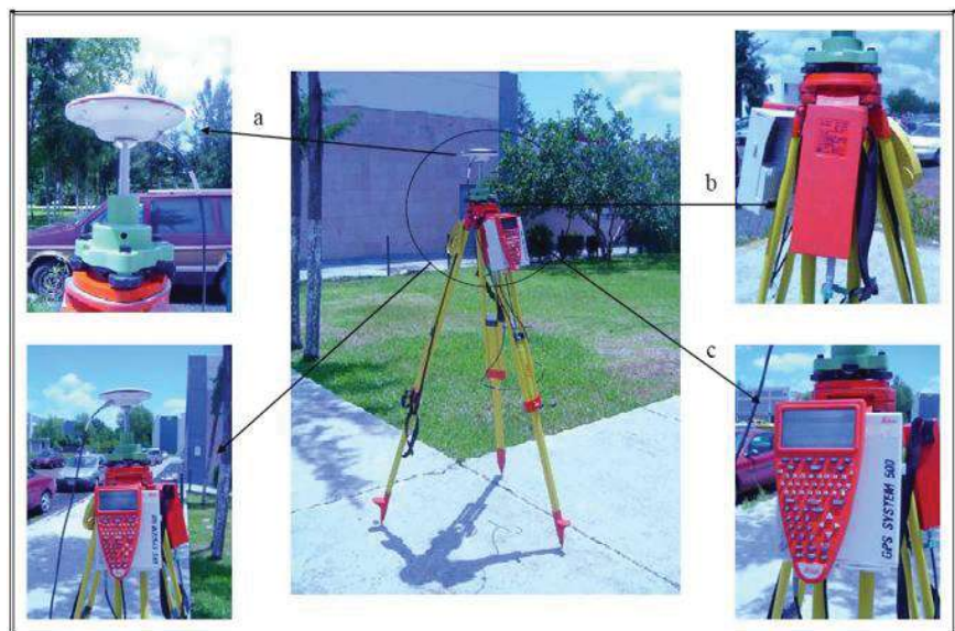
Fig. 29.- Elementos del Equipo GPS 500 a) Antena Microstrip L1/L2 AT502 b) Batería Externa c) Receptor GPS RS500 y Terminal GPS TR500
