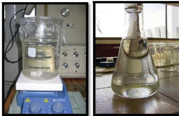
Figura 2.2. Preparación y separación de insolubles de solución de sulfato de aluminio grado industrial.
