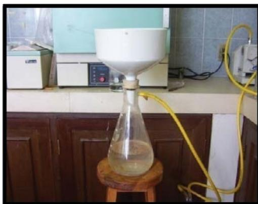
Figura 2.7. Proceso de filtración del gel
