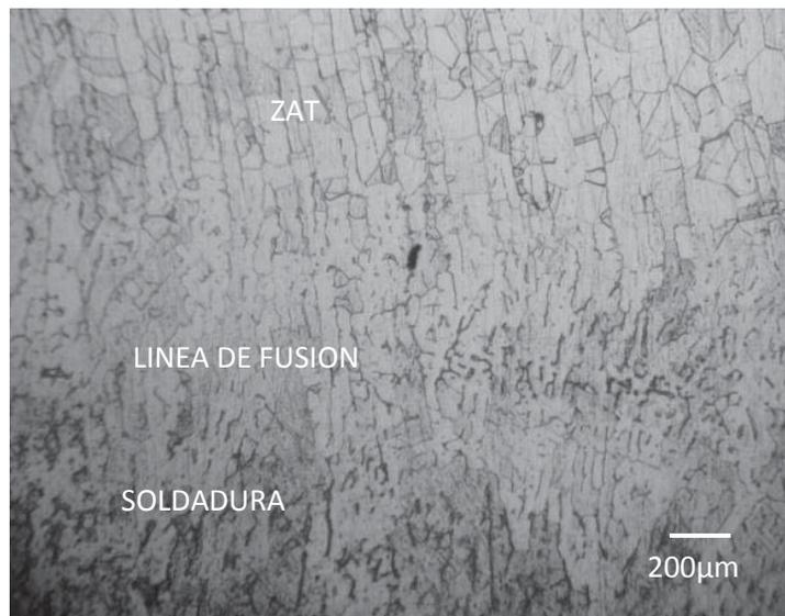
Figura 5.9. Micrografía de soldadura con aplicación de interacción electromagnética de 24mT (acero inoxidable 316L).
