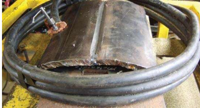
Figura 3.7. Placas unidas con proceso SAW utilizando bisel de 120°; con aplicación de 3 espiras en la bobina para el campo magnético.
