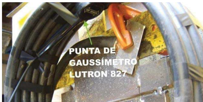
Figura 3.13. Colocación del Gaussímetro Lutron 827 dentro de la bobina de campo magnético con 6 vueltas en el proceso de arco sumergido no convencional [2].
