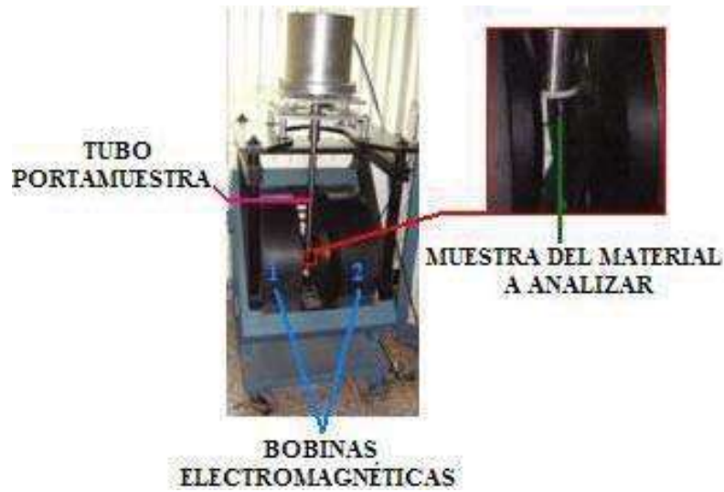
Figura 3.4. Magnetómetro utilizado para la medición de magnetización de los materiales [2].
