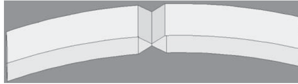
Figura 3.3. Diseño de junta de placas para unión por proceso de arco sumergido [2].
