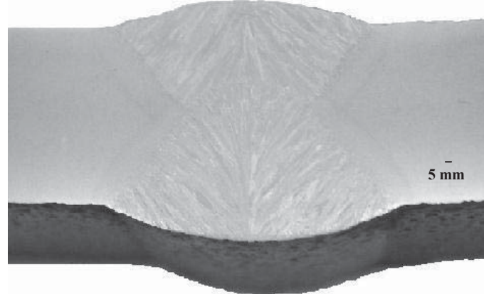
Figura 2. Unión de tubería con soldadura en doble “V” mostrando el típico crecimiento columnar [5].
