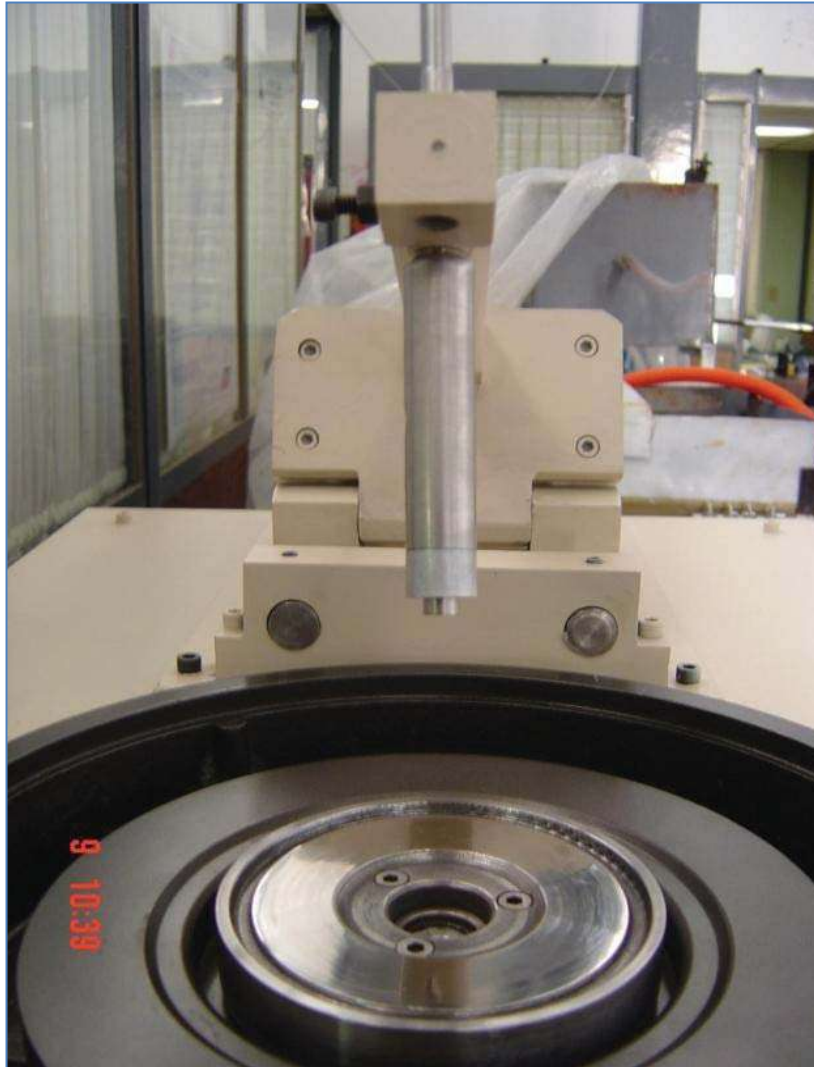
Figura 4.3 Separación entre la probeta y el disco de desgaste, permitiendo la colocación de la probeta en la base de la varilla porta probetas.
