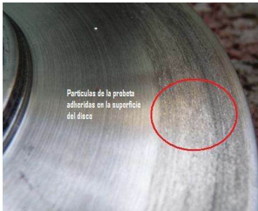
Figura 4.23 Imagen que muestra la adherencia de partículas de desgaste en la superficie del disco.
