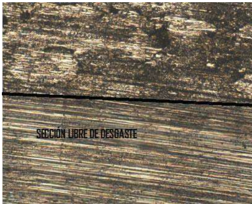
Figura 4.27 Microfotografía que muestra la frontera entre dos zonas, una desgastada bajo la aplicación de una carga de 68.6 N y otra sin desgaste, 50 x.
