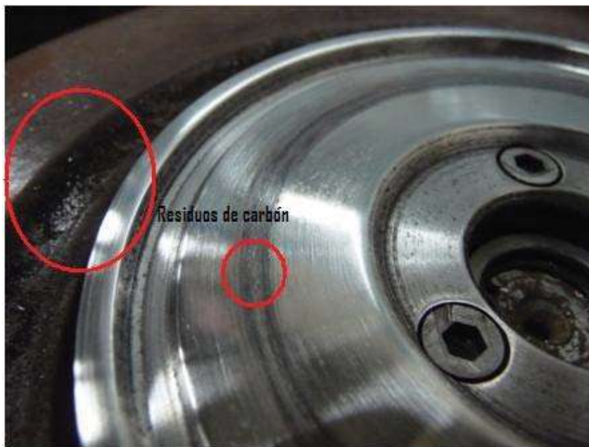
Figura 4.22 Imagen que muestra los residuos de óxido de tono oscuro presentes durante el ensayo de fricción para una carga de 44.1 N.
