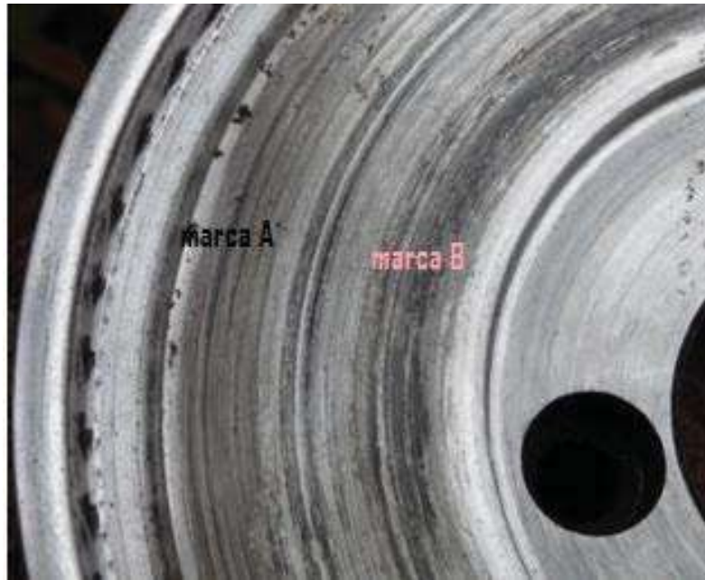
Figura 4.21 Marcas en la superficie del disco de desgaste. La marca A muestra una tonalidad rojiza producto de la presencia de óxido. La marca B demuestra una coloración más oscura, reflejo del incremento de la temperatura presente en el ensayo.
