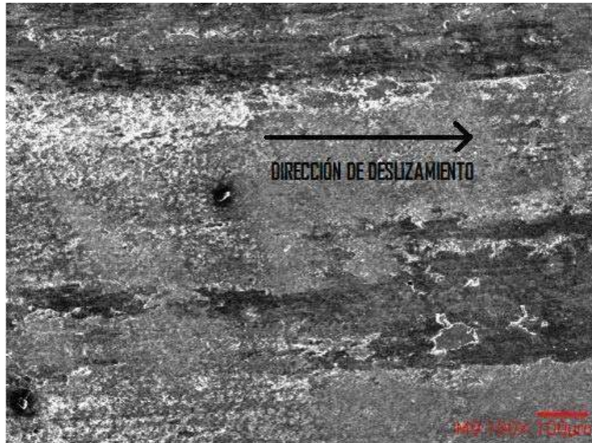
Figura 4.32 Superficie de una probeta sometida a desgaste bajo carga de 41.1 N y velocidad de deslizamiento de 0.75 m/s, vista a 100X.
