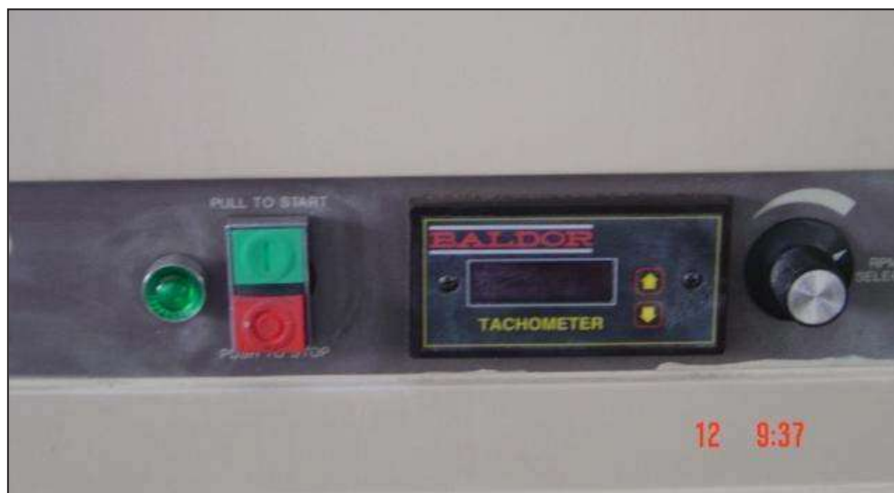
Figura 3.14 Instrumentación de control: (de izquierda a derecha) luz indicadora de encendido, botonera de arranque y paro de motor, tacómetro y selector de velocidad en rpm.
