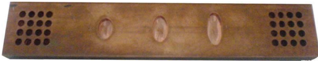
Figura 2.1 Probeta con barrenos pasados para el intercambio de calor.
