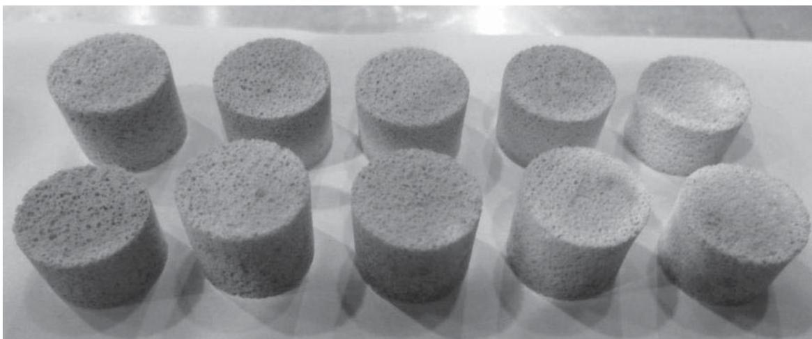
Figura 3.6 Espumas de vidrio 45S5 obtenidas después del proceso de pirólisis.
