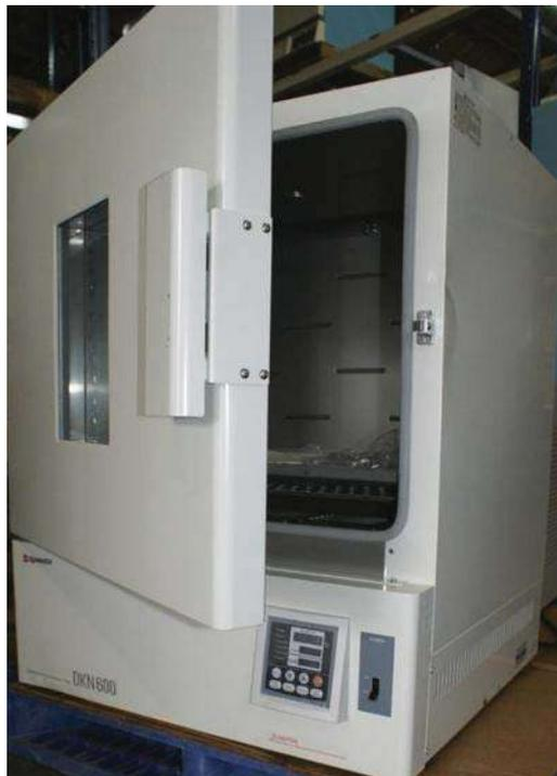
Figura 2.6 Horno por convección usado para la fabricación de las espumas.
