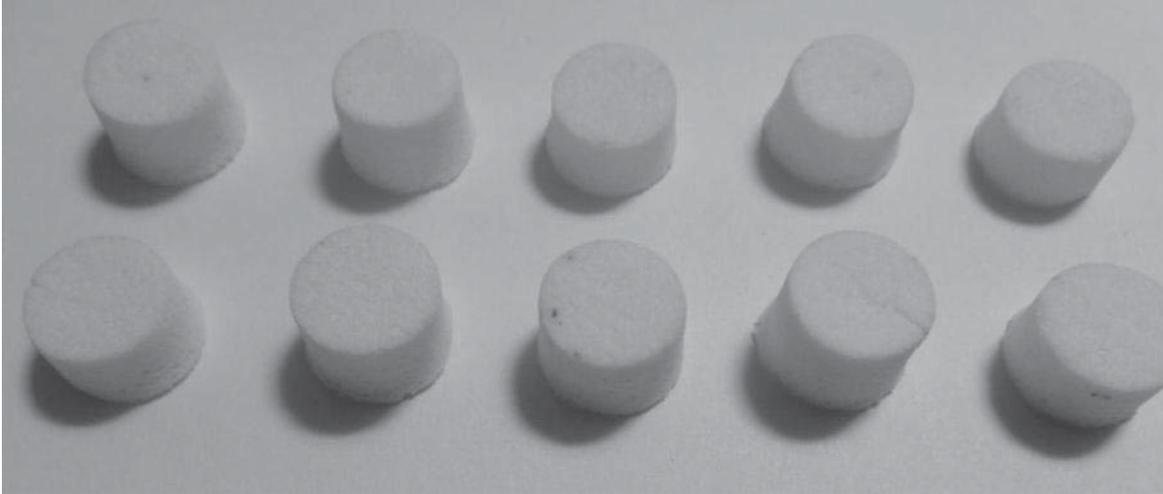
Figura 3.7 Espumas de vidrio 45S5 obtenidas después del proceso de sinterizado a 1000°C por 1h.
