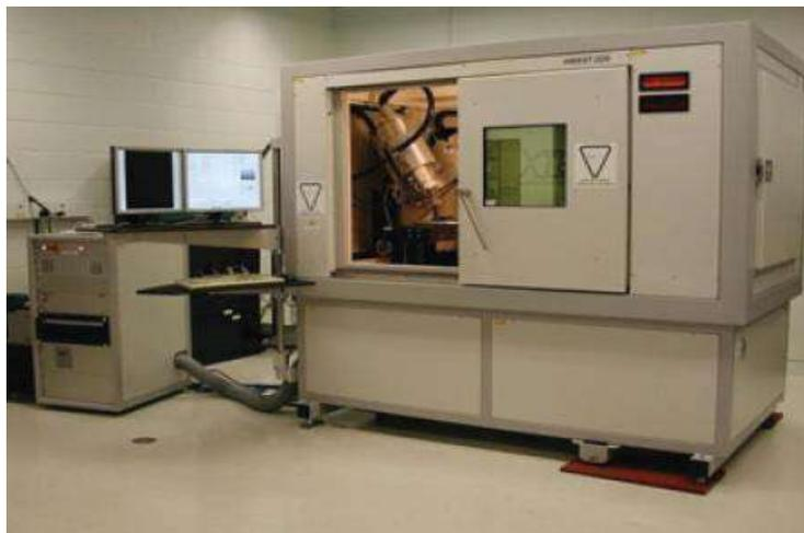
Figura 2.7 Sistema XTek HMXST 225, equipo para obtener imágenes de microtomografía.
