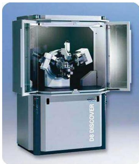
Figura 2.2 Difractómetro de rayos X Bruker AXS D8 Discover usado para obtener los datos cristalográficos del vidrio.
