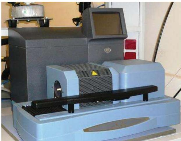
Figura 2.3 Equipo de análisis térmico simultáneo TGA/DSC.
