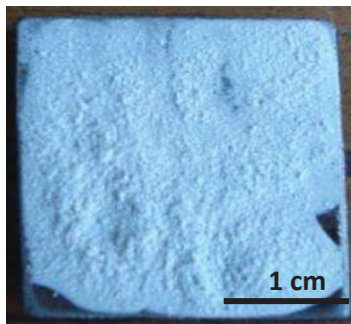
Figura 2.3. Pintura de fundente aplicada sobre sustrato de acero.
