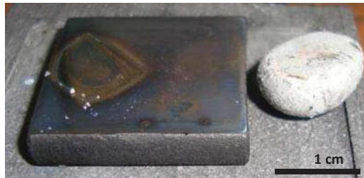
Figura 3.1. Experimento de referencia sin fundente para observar adhesión de la aleación Al-Si sobre el sustrato de acero.
