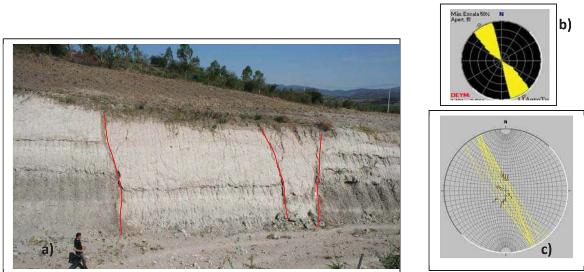
Figura 6.27 Estación 11AeroTunel. a) Fallas normales; b) Diagrama E_y ; c) Estereogramas.
