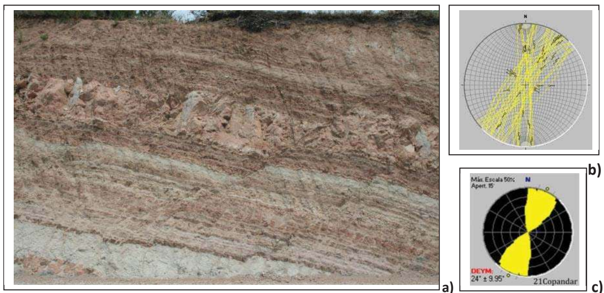
Figura 6.25 Análisis de datos de la estación 31Copandar. Horizontes piroclásticos fallados y basculados (foto a). Planos de desgarre reactivados como normales (estereograma b) y dirección NNE-SSO de máxima compresión horizontal (Ey) compatible para ambos sistemas (diagrama c).
