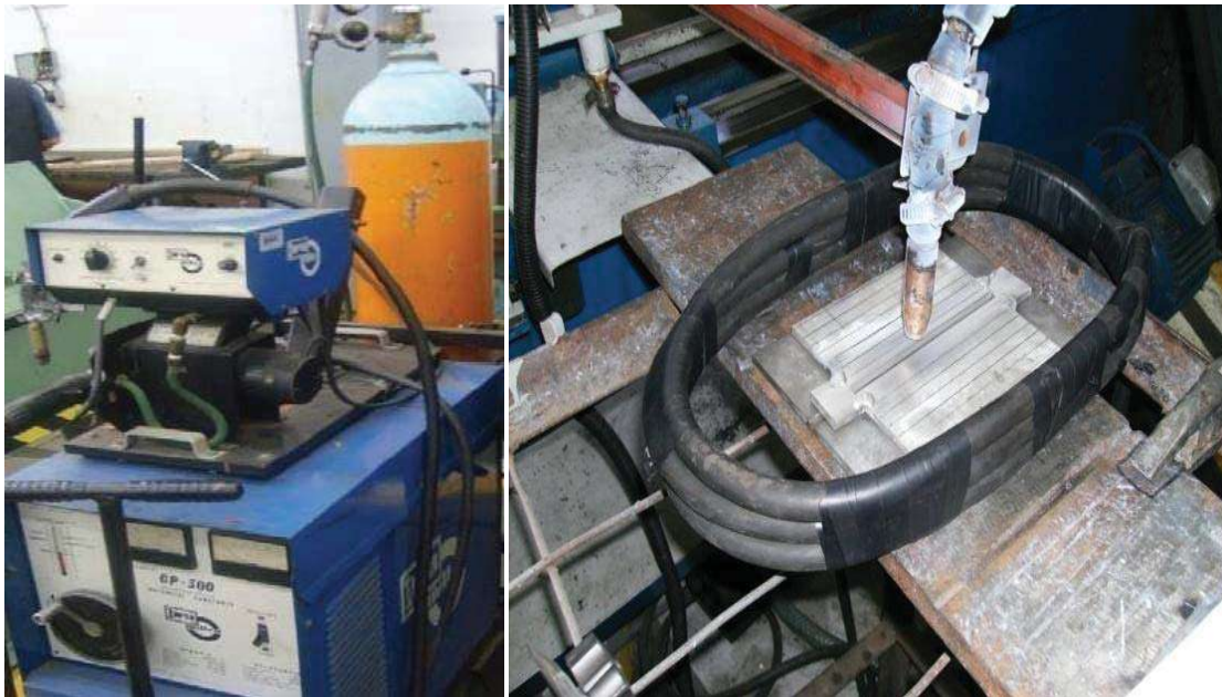
Fig. 2.4.- Equipo utilizado para soldar (a) máquina de soldar (b) bobina para inducir el campo magnético.
