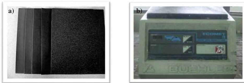
Figura 3.8 (a) Lijas de diferentes tamaños de grano y (b) maquina pulidora Bueher Ecomet 3.
