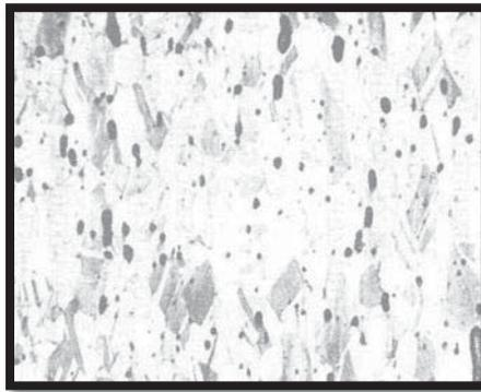
Figura 2.10 Varilla extruida de latón cortada libremente que muestra los glóbulos de plomo alargados. Esto indica que la estructura está en la fase  $\alpha$ . (Solución de ataque  $\text{NH}_4\text{OH} + \text{H}_2\text{O}_2$ ; ampliación 75x) <sup>(1)</sup>.
