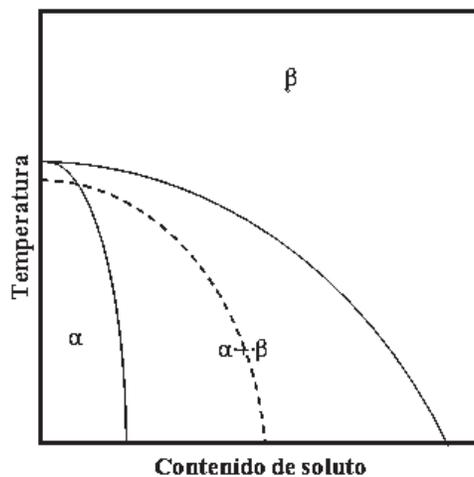
Figura 2.3 Diagrama de equilibrio del titanio con un elemento  $\beta$ -estabilizante.
