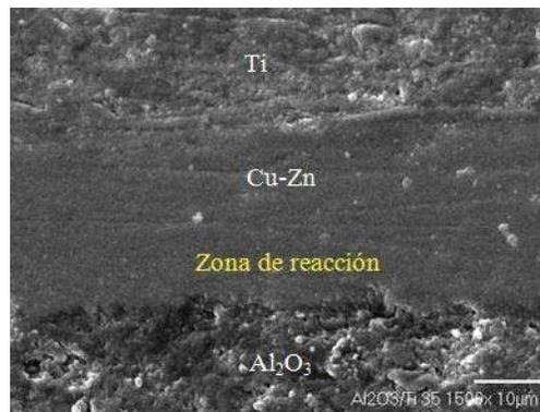
Figura 4.17 Sección transversal de ensamble  $\text{Al}_2\text{O}_3/\text{Cu-Zn}/\text{Ti}$  a  $970^\circ\text{C}$  a 35 minutos a 1500x (escala  $10\mu\text{m}$ ).
