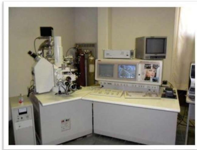
Figura 3.14 Microscopio Electrónico de Barrido JOEL, modelo JSM – 6400.
