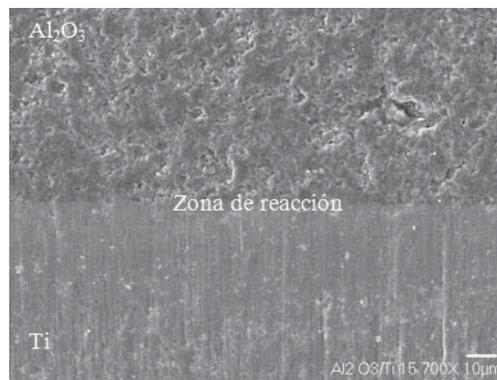
Figura 4.13 Sección transversal de la unión de  $\text{Al}_2\text{O}_3/\text{Cu-Zn}/\text{Ti}$  a  $970^\circ\text{C}$  por 15 minutos a 700x (escala  $10\mu\text{m}$ ).
