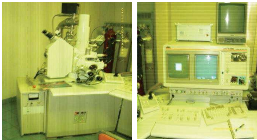
Figura 2.6.- Microscopio de emisión termoiónica JEOL JMS-6400 utilizado.
