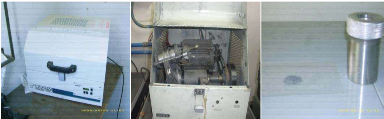
Figura 2.3.- Molino de alta energía SPEX 8000D a) exterior, b) interior, c) contenedor, y polvos producidos después de la molienda.
