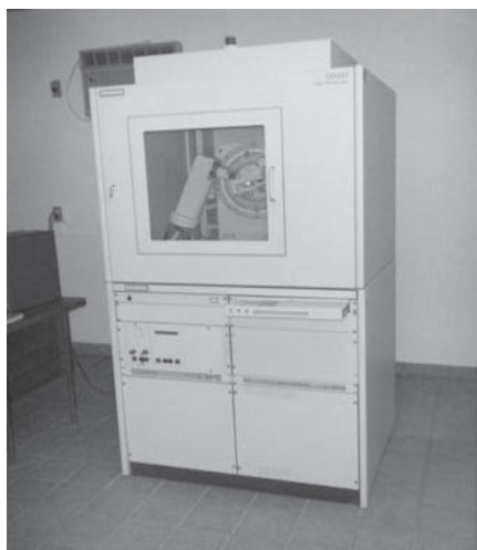
Figura 2.4.- Difractómetro Siemens D5000 utilizado para la caracterización estructural de todas las muestras (intermetálico y polvos).
