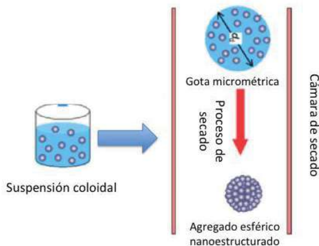
Figura 2.3 Esquema de la preparación de polvos de \text{BaFe}_{12}\text{O}_{19} mediante la técnica de secado por aspersión.
