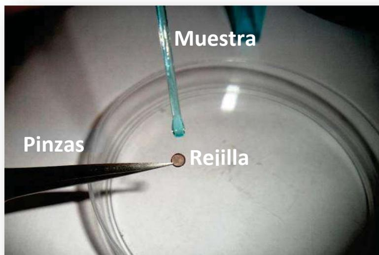
Figura II.4. Esquema de la preparación de la muestra.
