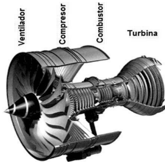
Figura 2.12 Corte transversal y componentes de una turbina moderna (Rolls-Royce Trent 1000) [43].
