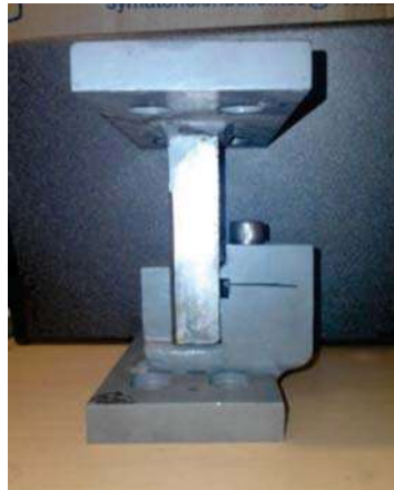
Figura 3.8 Esquema y fotografías del dispositivo para ensayos mecánicos al corte.
