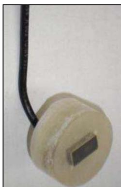
**Figura 2.5.-** Electrodo de trabajo para las pruebas electroquímicas.
