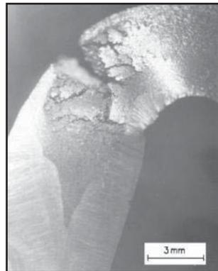
**Figura 1.1.-** Falla por corrosión intergranular en la ZAC de un acero soldado 316 [5].
