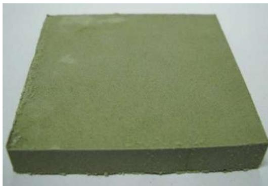
Figura 4.21. Placa de polvo de vidrio a una presión uniaxial de 40MPa.
