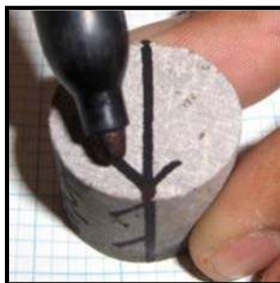
Figura 20. Colocación de la flecha en un espécimen para su orientación azimutal.
