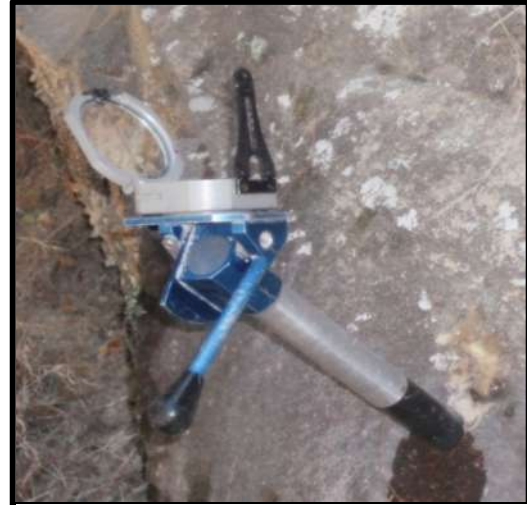
Figura 17. Se observa el inclinómetro y la brújula que se utilizaron para orientar las muestras.
