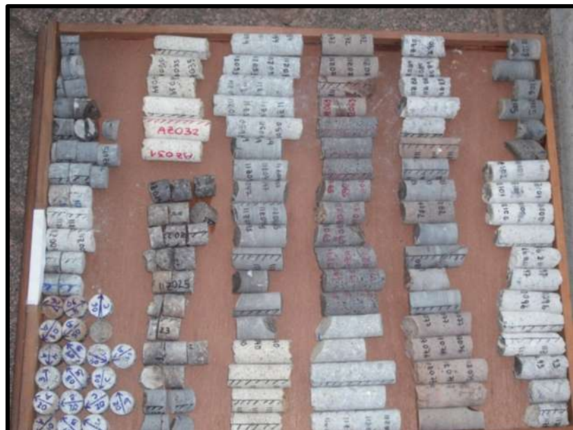
Figura 19. Núcleos recolectados en donde se observa que se encuentran enumeradas y marcadas.
