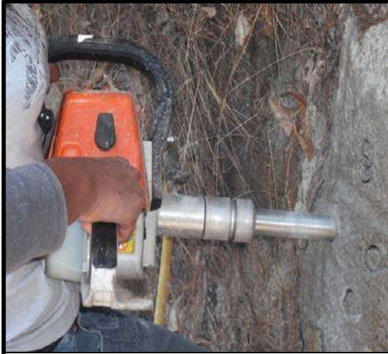
Figura 16. Perforadora portátil tipo POMEROY utilizada para extraer los núcleos.
