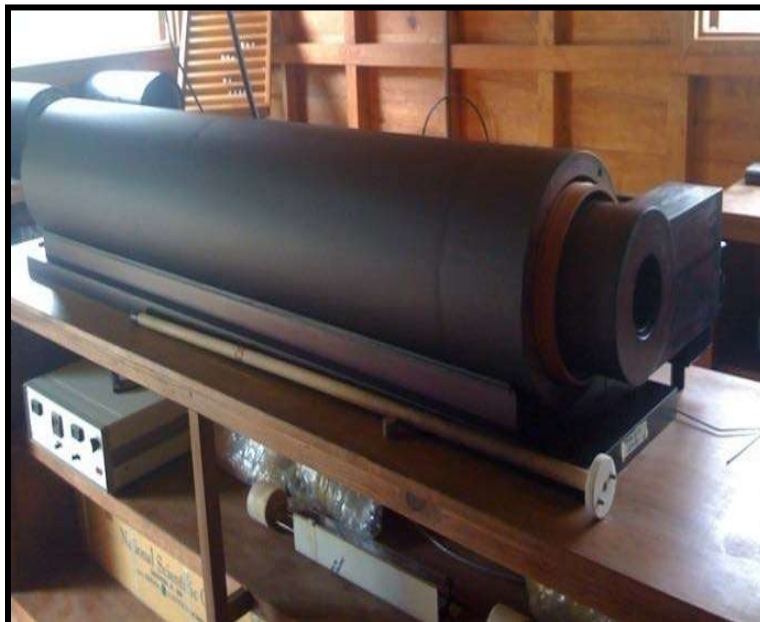
Figura 21. Horno ASC TD-48 usado para tratamientos térmicos.
