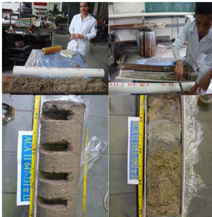
Figura 9.-Imagen de la apertura de los tramos y posterior muestreo y descripción.
