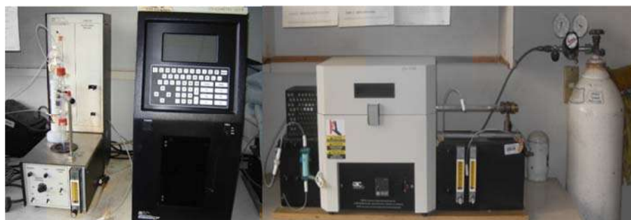
Figura 10.- Coulómetro (Marca: UIC, Modelo 5014).
