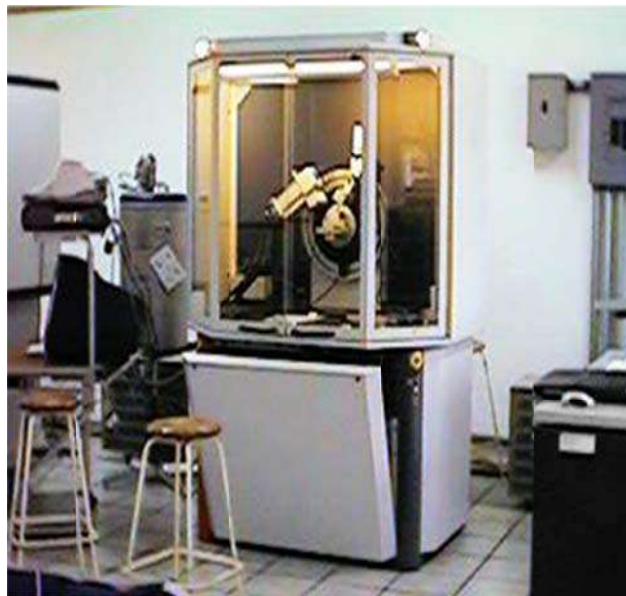
Figura 12.- Equipo de Difracción de Rayos X (SIEMENS D5000).
