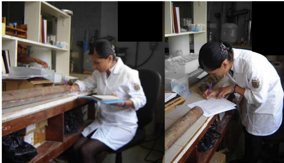
Figura 8.-Descripción estratigráfica del núcleo en el laboratorio de cuencas lacustres del Instituto de Investigaciones Metalúrgicas (IIM).
