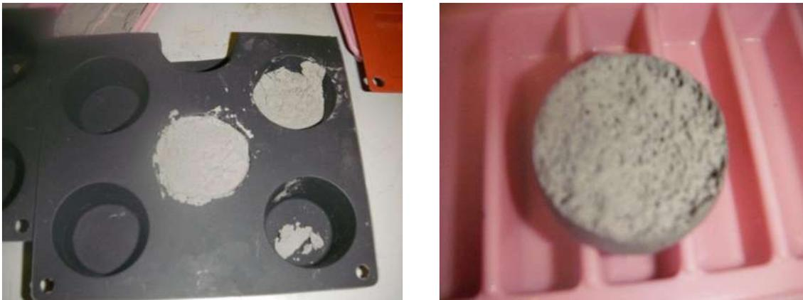
Figura 4.2. Fotografías tomadas en el sistema XG/LBG donde se puede observar el colapso de las espumas después de ser extraídas del horno. La imagen del lado derecho, representa el fondo de la espuma (drenado).
