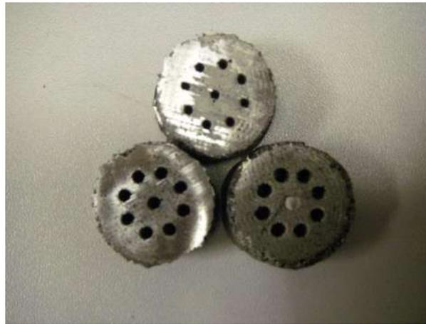
Figura 4. 12. Moldeo de espumas de acero inoxidable obtenidas por vaciado de geles en una solución de metilcelulosa al 2%.
