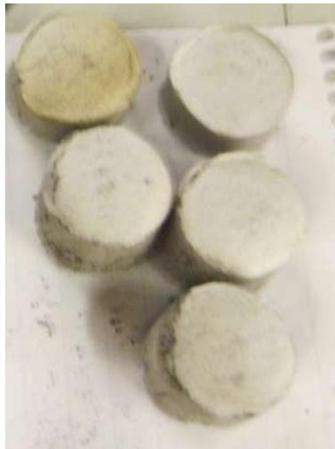
Figura 4. 15. Espumas sinterizadas después de un proceso de quemado en verde.
