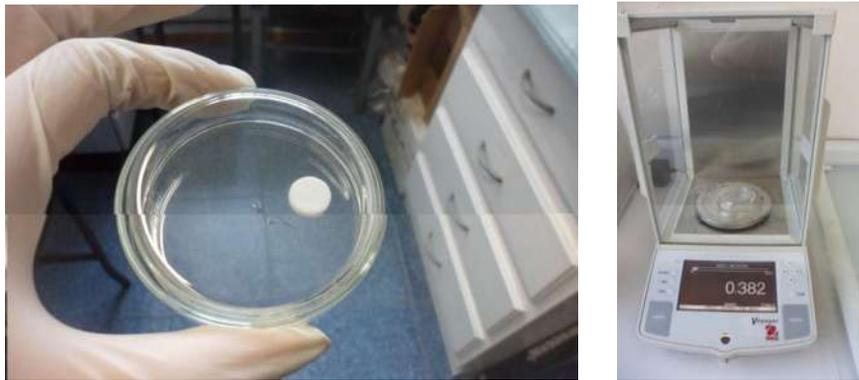
**Fig 3. 21** Disco dentro de la caja petri, listo para ser secado a 120° C y después pesado.
