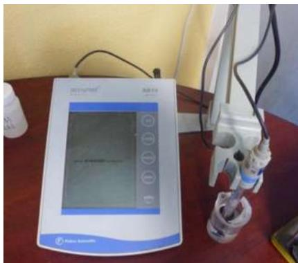
**Fig 3. 19** Medidor de pH Fisher scientific AB15, usado para medir el pH de la solución después de cada tiempo de inmersión. (Instituto de investigaciones Químico- Biológicas, UMSNH)
