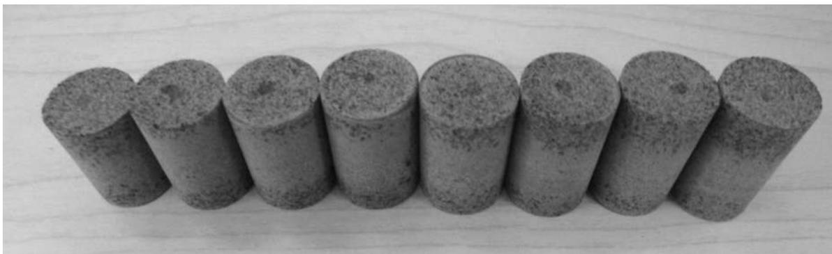
**Fig 4. 4** Espumas de biovidrio antes de la pirólisis y el sinterizado.
