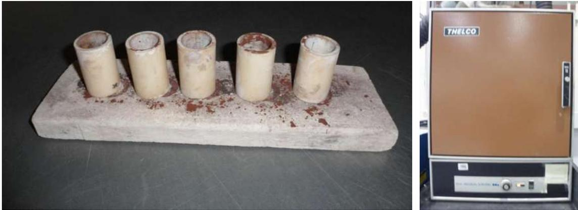
**Fig 3. 5** Moldes utilizados para espumar las probetas y horno eléctrico tipo mufla, usado para el perfil térmico.
