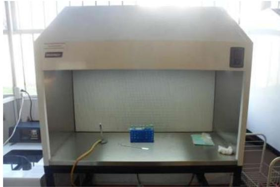
**Fig 3. 16** Campana de flujo laminar usada para el proceso de inmersión de los discos.
