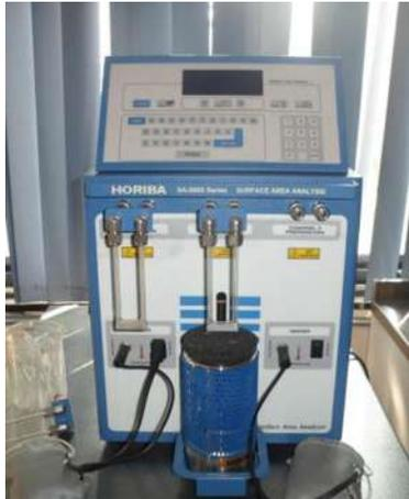
**Fig 3. 13** Analizador de área superficial, HORIBA- SA 9600 series.
