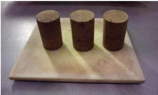
**Fig 3. 9** Acomodo de las probetas en la placa para un mejor sinterizado.
