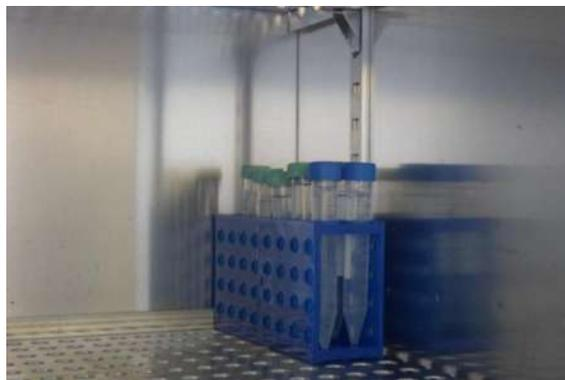
**Fig 3. 18** Tubos con la solución utilizada de cada muestra para analizar sus pH, mantenidos a 37°C en una estufa biológica.
