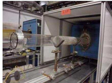
**Fig 3. 8** Horno usado para la pirólisis y sinterización de las probetas.
