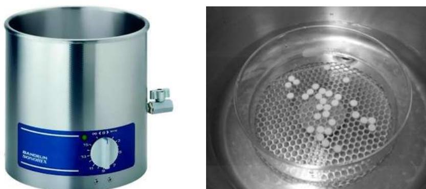
**Fig 3. 15** Baño de ultrasonido radial utilizado para la esterilización de las pastillas.
